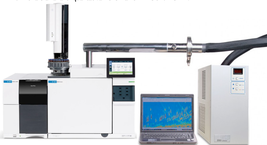
Sistema GC×GC con modulatore termico Zoex controllato da un'unità SRA Optimode V2 e spettrometro di massa 5977C con sorgente Extractor (Agilent Technologies).
