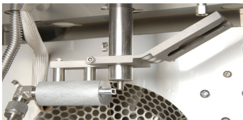
Modulatore termico a loop Zoex con unità di refrigerazione a circuito chiuso ZX2 (ZOEX Corporation).
