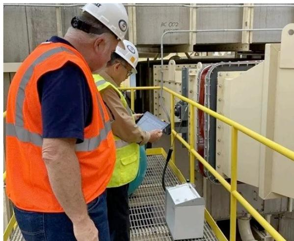
Tablet per controllare lo strumento entro 50 metri tramite WiFi.
