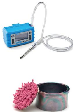
Figura 2: (in alto) Pompa di campionamento Acti-VOC con tuba assorbente (in basso) Microcamera con campione di esempio.
