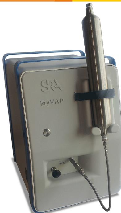
*Il vaporizzatore MyVap alloggia la bombola del campione ed esegue automaticamente la sequenza di analisi.*
