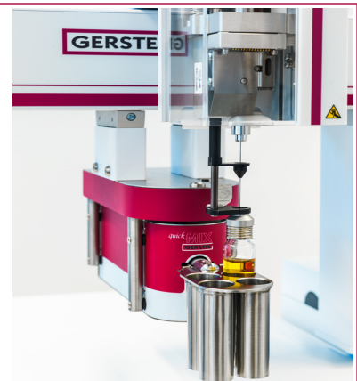
In alto: quickMIX - La frequenza di oscillazione fino a 4000 Hz assicura un completo e veloce contatto tra le fasi, con conseguente massimizzazione dell'efficienza estrattiva.
