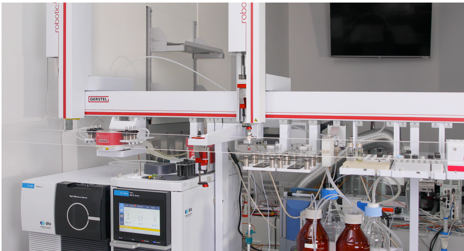
Sopra: Visione d'insieme del preparatore/ iniettore robotico Gerstel MPS Robotic PRO abbinato al sistema analitico Agilent GC/MS-MS Intuvo 9000 / QQQ 7010B.
