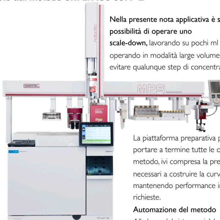
La piattaforma preparativa proposta è in grado di portare a termine tutte le operazioni richieste dal metodo, ivi compresa la preparazione degli standard necessari a costruire la curva di calibrazione, mantenendo performance in linea con quelle richieste.
