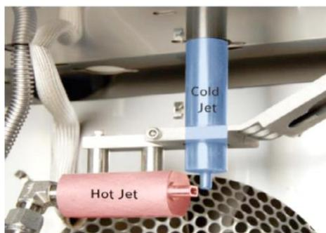
La tecnica GC×GC basata su modulatore termico (loop-type thermal modulator - Zoex), accoppiata al singolo quadrupolo, è stata utilizzata come tecnica di riferimento per la determinazione quantitativa degli allergeni regolamentati dalla Direttiva 2003/15/EC; la validazione di tali metodiche è stata oggetto di pubblicazioni scientifiche su riviste internazionali.
