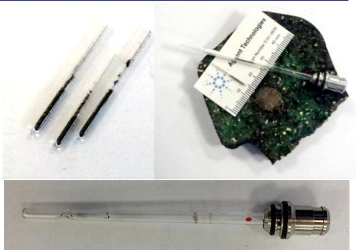
Per ogni campione sono state fatte delle prove introducendo il campione senza separazione cromatografica con una rampa di riscaldamento dell'iniettore lenta, fino a temperatura di 350°C. In questo modo è stato possibile valutare le molecole emesse durante la fase di termodesorbimento.
