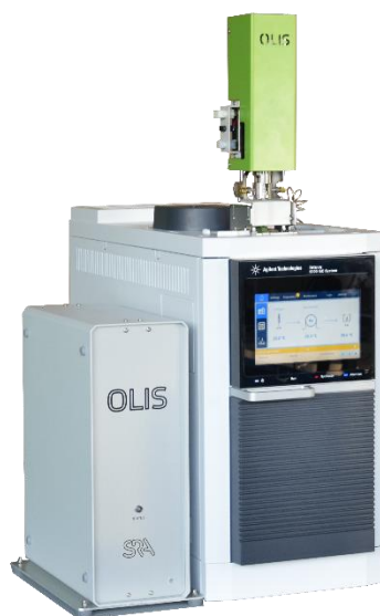
OLIS valve installed on Intuvo 9000 GC
