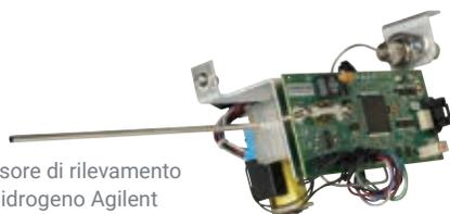
Sensore di rilevamento dell'idrogeno Agilent
