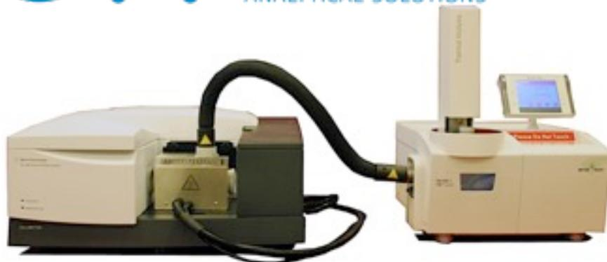
**L'interfaccia SRA T-IR660 consente il trasferimento dei gas evoluti in TGA al sistema di analisi FTIR Agilent Cary 660.**
