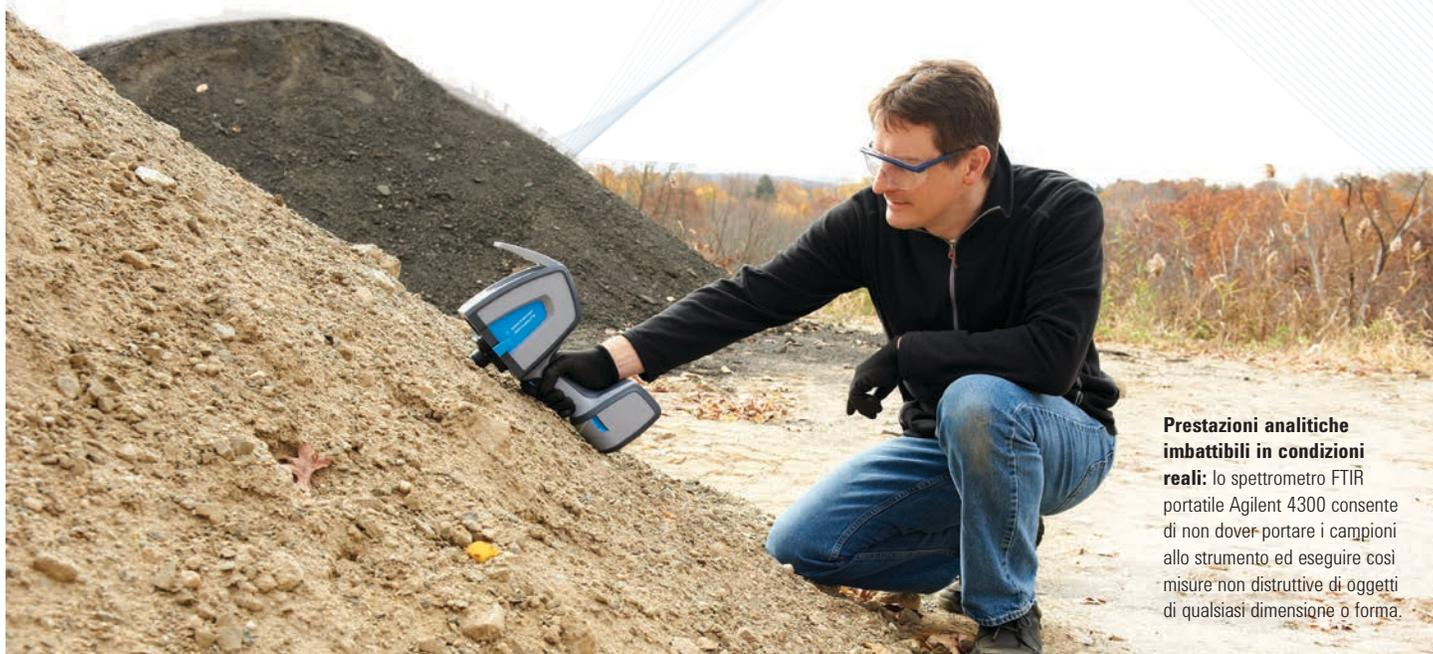
**Prestazioni analitiche imbattibili in condizioni reali:** lo spettrometro FTIR portatile Agilent 4300 consente di non dover portare i campioni allo strumento ed eseguire così misure non distruttive di oggetti di qualsiasi dimensione o forma.
